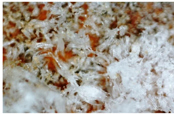
Fot 7, 8, 9. Fragment ściany ceglanej pomiędzy pomieszczeniami piwnicznymi, widoczne wysolenia. Po prawej stronie zdjęcia mikroskopowe kryształków soli. Budynek „Kossakówka, Pl. Kossaka 4, Kraków. Fot. D. Narowska Avonza, styczeń 2022 r.
